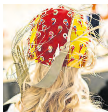
So sieht eine EEG-Haube mit Elektroden für die EEG-Messung aus. Foto: dpa/Jacob Schröter
