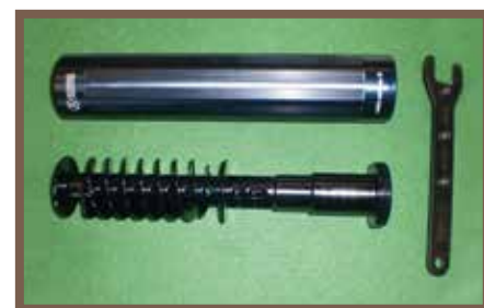
Zerlegter Dämpfer der Firma Mohring, Dämpfungsleistung 22 – 34 dB, Overbarrel, Gesamtlänge 24,5cm, Länge ab Mündung 18,5cm; rechts im Bild das Zerlegewerkzeug.
