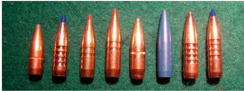
v.l.n.r.: E Kaliber .308, 9,7 g Hornady TMS Blei; Barnes TTSX; Hornady GMX; Hornady GMX 10,7 g; 11,7 g Hornady TMS Blei; Barnes XRL; Barnes TSX; Barnes TTSX
